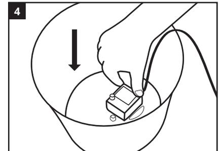
Replace pump. Replacer la pompe. Setzen Sie die Pumpe wieder ein. Vuelva a instalar la bomba. Plaats de pomp terug.
