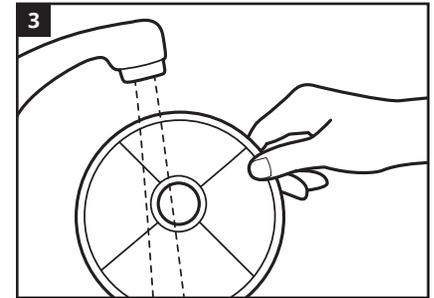
Rinse filter to remove excess dust. Rincer le filtre pour retirer l'excédent de poussière. Spülen Sie den Filter ab, um überschüssigen Staub zu entfernen. Enjuague el filtro para sacar el exceso de polvo. Spoel de filter om stof te verwijderen.
